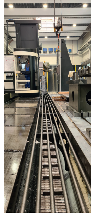
4 Die gewählte Kairos hat einen Verfahrweg von 12 m © Herrlinger Werkzeugmaschinen
