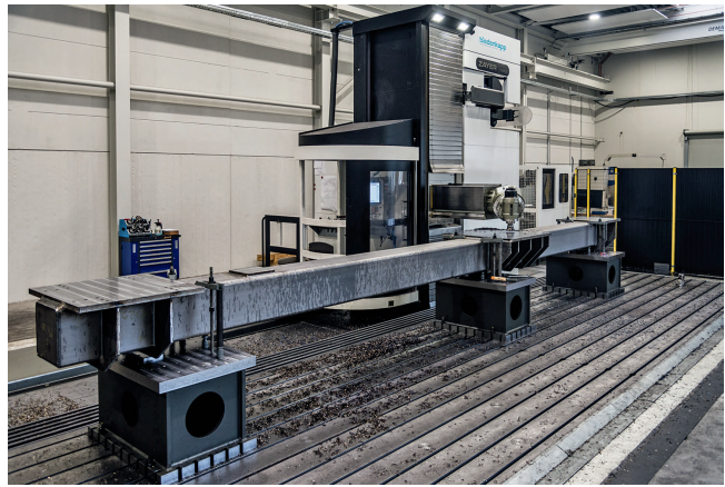
2 Mit 12 m Längs-, 3 m Vertikal- und 1600 mm Querverfahrweg der Iberimex-Zayer Kairos bearbeitet Biedenkapp jetzt problemlos auch Großteile im eigenen Haus © Biedenkapp
